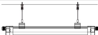
Befestigen Sie die Leuchte mit Hilfe der Montagehalter an dem Seilsystem.
