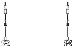
Bohren Sie im gewünschten Abstand Löcher in die Installationsfläche. Montieren Sie das Seilsystem mit Hilfe von Dübeln und Schrauben.
