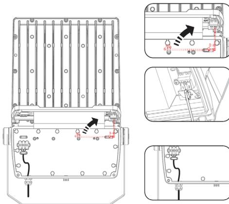
1. Abdeckung öffnen und Deckel-Haltebügel aufrichten
